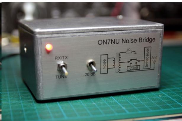
N'oubliez pas de basculer l'atténuateur en fonction du QRM présent dans l'air et aussi veillez à ne pas saturer le récepteur afin de trouver précisément le minimum au S-mètre.
