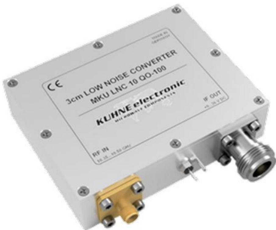
Ce LNC sera monté et raccordé directement derrière la tête ; la descente se faisant en coax 50Ω soit vers un transceiver moderne UHF avec waterfall (IC-9700), soit vers une clé SDR-RTL et le PC avec SDR Console. Tout comme pour le LNB, il faudra jouer sur l'inclinaison (skew) de l'antenne bi-bande, celle-ci étant en polarisation verticale pour la réception NB.
