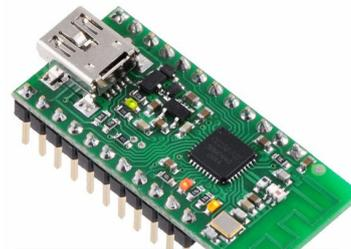
Module polyvalent, programmable, avec support radio 2.4Ghz. Basé sur le CC2511F32 de Texas Instrument
