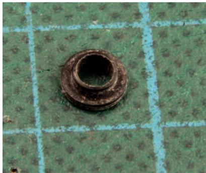
Rondelle d'isolation pour transistor
