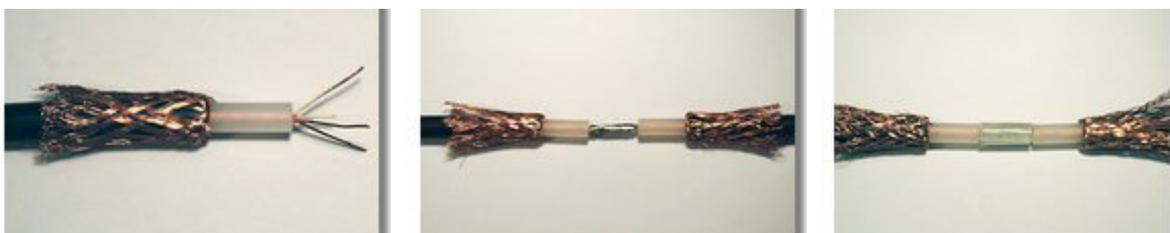
**Fig. 4** - Enfiler sur un des morceaux de coax 1 gaine thermo rétractable de 6 cm puis sur l'autre morceau de coax 1 gaine thermo rétractable de 10 cm de long.
