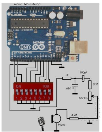
Un Arduino Uno ou nano, un intégrateur R.C., un dip switch, un atténuateur, un condensateur de liaison.
